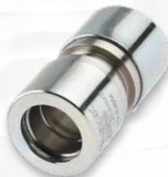
Das HAELOK® THERMO®-Fitting «SR» (Straight Repair Fitting) wird für eine gerade Verbindung von zwei Fernwärmehämmen benutzt. Das Fitting kann über das ganze Rohr verschoben werden um Reparaturen auszuföhren. Es ist speziell optimiert auf hohe Auszugskräfte und Temperaturlastwechsel. Das Fitting besteht aus insgesamt drei fix montierten Bauteilen; einem Grundkörper und zwei Pressringen.
