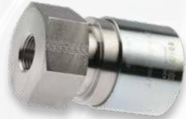
Das HAELOK®- Fitting, Typ «TI» (Thread Internal), wird zum Anschliessen von Armaturen oder Löschdüsen benutzt. Das Innengewinde wird nach Norm ISO 228-1 (zylindrisch parallel) mit einer Einschraubbohrung nach Norm ISO 1179-1 gefertigt. Das Fitting besteht aus insgesamt zwei fix montierten Bauteilen; einem Grundkörper und einem Pressring. Sonderanfertigungen mit Spezialgewinde z.B. NPT sind möglich.
