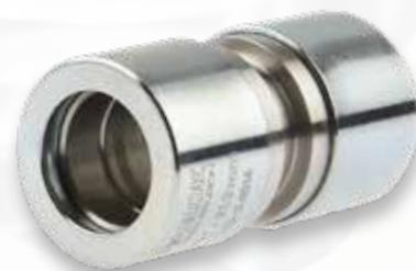
Das HAELOK®- Fitting, Typ «SR» (Straight Repair) wird für eine gerade Verbindung von zwei Röhren benutzt. Durch den fehlenden Anschlag kann das Fitting über das ganze Rohr verschoben werden um Reparaturen auszuführen. Das Fitting besteht aus insgesamt drei fix montierten Bauteilen; einem Grundkörper und zwei Pressringen.
