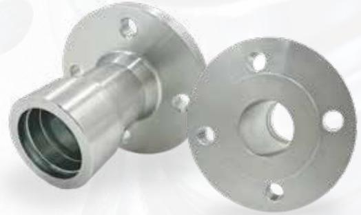
Das HAELOK®- Fitting, Typ «FD» (Flansch), ist eine lösbare Verbindung zu Ventilen, Pumpen und Tanks. Wir bieten die PN40 Flanschverbindung, dessen Flanschseite gemäss DIN 2633 produziert ist, an. Die Standardgrössen reichen von DN 20 bis DN 50. Die Flansche werden ohne Dichtungen und Verbindungsmittel geliefert. Das Lochbild passt ebenfalls zu Flanschen der Reihe PN16 und PN25.
