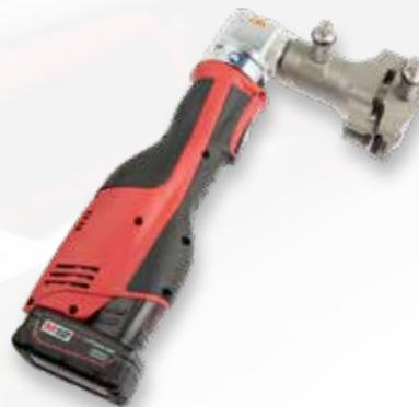
Das Presswerkzeug besteht aus einem hart eloxierten Gehäuse sowie einem wartungsfreien Schliessmechanismus. Die akkubetriebene Hydraulikeinheit entspricht dem letzten Stand der Technik und garantiert eine einwandfreie und sorglose Installation in jeder Situation. Durch das einfache Drehen der Hörner, kann das Presswerkzeug den Bereich von 6.35 mm bis 13.5 mm Aussendurchmesser abdecken. Alle HAELOK®- Presswerkzeuge sind geprüft und CE-konform.
